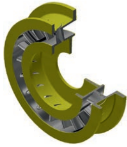
Рис. 8. Технологические припуски и литьевые уклоны (выделены цветом) на примере СА
