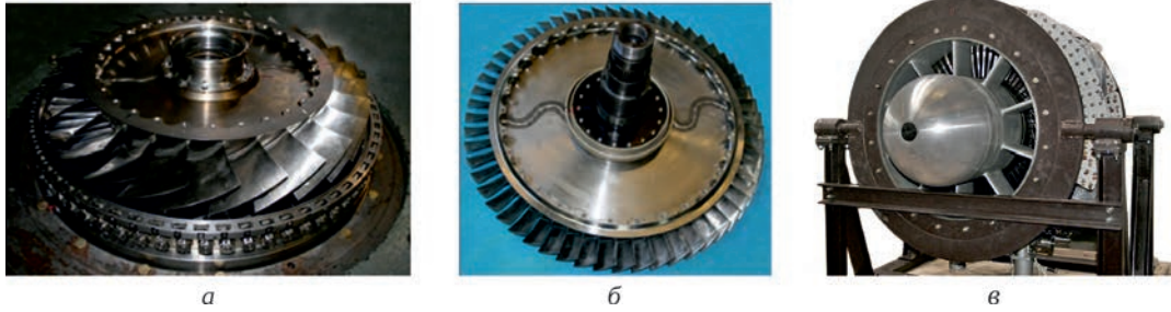
Рис. 2. Компрессор НРС-2. Ротор первой (а) и второй (б) ступеней и общая сборка (в)
