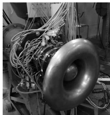
Рис. 3. Экспериментальная модель кольцевой жаровой трубы
