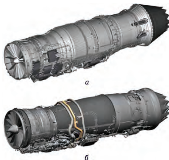
Рис. 9. Демонстрационные адаптивные трехконтурные двигатели компаний General Electric (а) и Pratt & Whitney (б)
