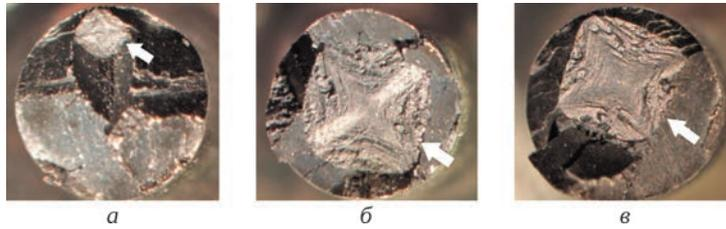
**Рис. 10.** Примеры изломов образцов сплава СЛЖС-3 с КГО <001> после испытаний на МЦУ ( $R_\varepsilon = 0$ ) при  $T = 850^\circ\text{C}$  (стрелками показаны квадратные фасетки): *a* –  $N_f = 4147$  циклов;  $\Delta\varepsilon = 1,4\%$ ; *б* –  $N_f = 8484$  цикла;  $\Delta\varepsilon = 1,2\%$ ; *в* –  $N_f = 23906$  циклов;  $\Delta\varepsilon = 1,0\%$
