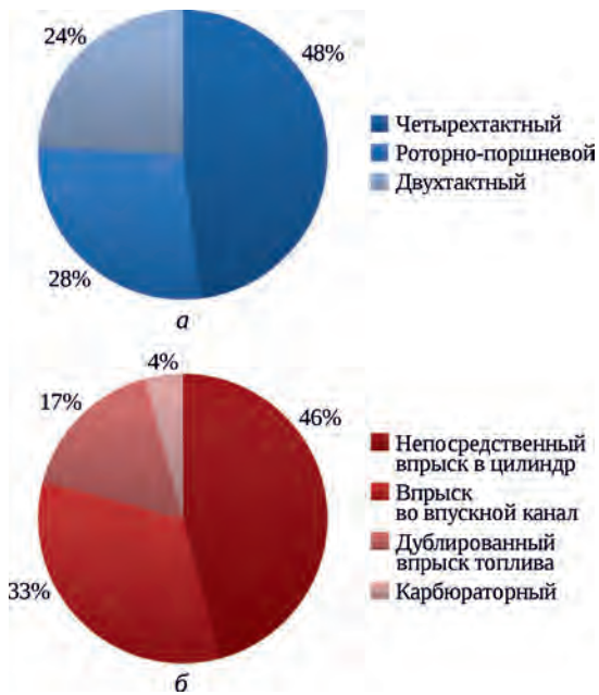
Рис. 3. Распределение предпочтений разработчиков и производителей ЛА и БЛА относительно АПД: а – по способу организации рабочего процесса; б – по способу смесеобразования
