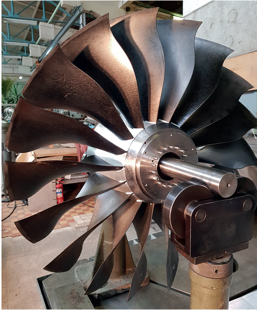
Рис. 2. Рабочее колесо модели вентилятора МВр с лопатками из ПКМ
