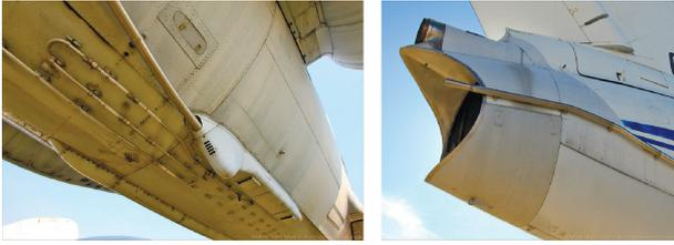
**Рис. 15.** Система аварийного сброса жидкого водорода [3] тивных двигателей ограничивают применимость двигателя;
