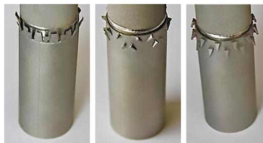
Рис. 22. Вихревые генераторы горелки типа DFI [17]
