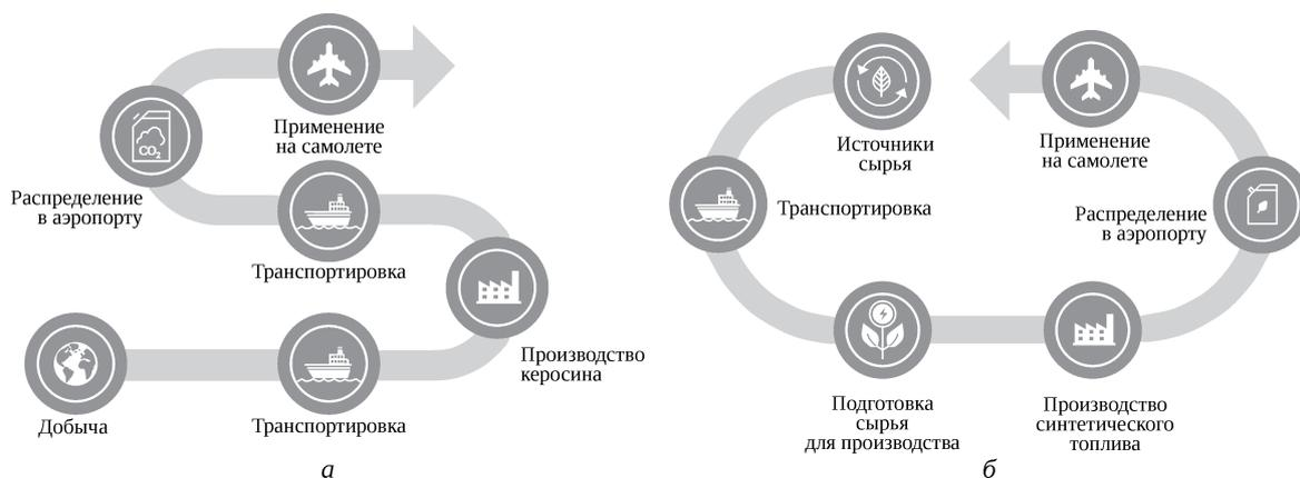
Рис. 2. Упрощенные схемы производства авиационного топлива [26]:
