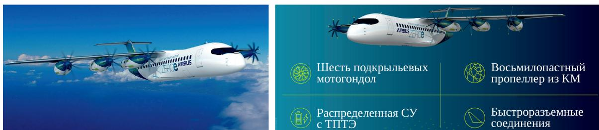
**Рис. 6.** Концепция перспективного пассажирского самолета компании Airbus с силовой установкой на водородных ТПТЭ [46]
