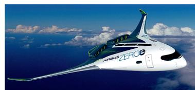
Рис. 5. Концепции перспективных пассажирских самолетов компании Airbus, использующие в качестве топлива жидкий водород [45]
