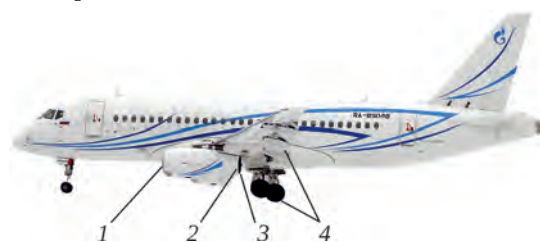
Рис. 1. Основные источники шума самолета: 1 – вентилятор и компрессор; 2 – вентилятор, турбина и камера сгорания; 3 – струя; 4 – планер
