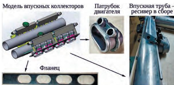
Рис. 8. Впускной ресивер: модель и изготовленные детали
