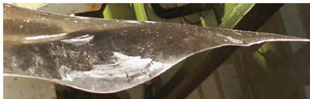
**Рис. 6.** Отгиб передней кромки задней лопатки в результате ударов испытываемой средней лопатки при забросе крупной птицы массой 2,86 кг
