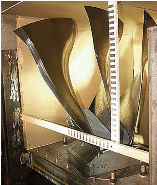
Рис. 3. Общий вид регулировочного устройства и сектора из трех лопаток
