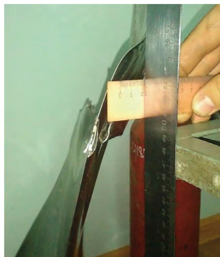
**Рис. 7.** К процедуре измерения остаточных отгибов передней кромки пера лопатки после удара
