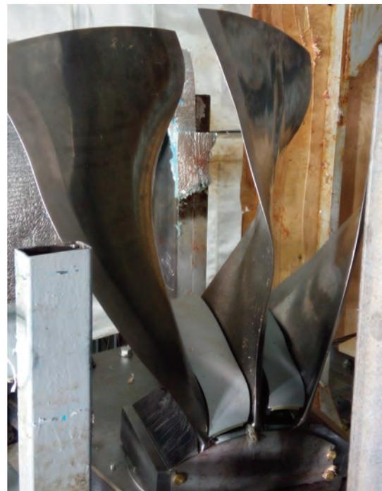
Рис. 4. Пакет из трех лопаток после удара по сечению средней лопатки на относительной длине пера ~0,5 птицей массой 1,44 кг со скоростью 268 м/с
