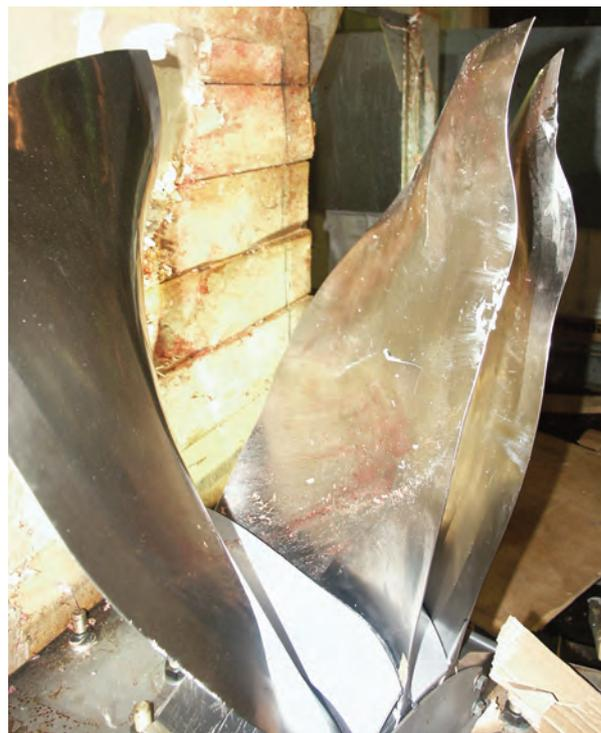
**Рис. 5.** Пакет из трех лопаток после удара по сечению средней лопатки на относительной длине пера  $\sim 0,75$  птицей массой 1,46 кг со скоростью 259 м/с
