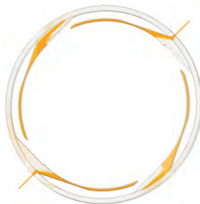
Рис. 2. Распределение масла в сечении маслозахватного кольца
