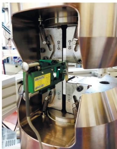
Рис. 11. Растягиваемый образец с экстензометром в оснастке испытательной машины
