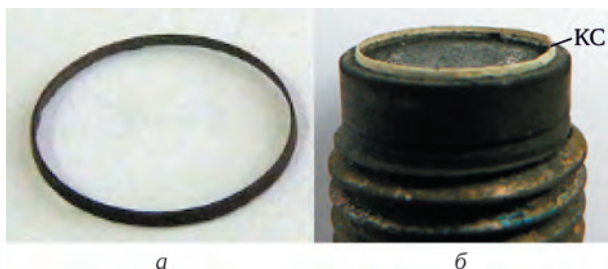
Рис. 15. Подслей и керамический слой после испытаний: а – отделившийся от образца металлический подслей; б – керамический слой, сдвинутый с поверхности подслоя
