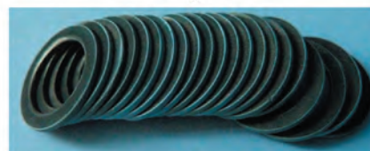
Рис. 11. Кольцевые образцы с ТЗП: а – собранные на оправке с промежуточными прокладками; б – снятые с оправки
