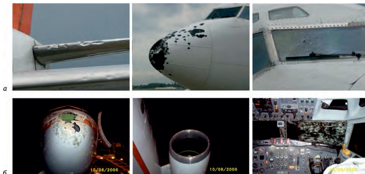
**Рис. 1.** Повреждения воздушного судна под воздействием града [1]:
