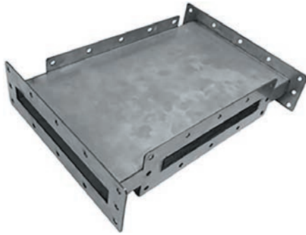
Рис. 7. Экспериментальный теплообменник, изготовленный по предлагаемой методике с применением лазерных технологий
