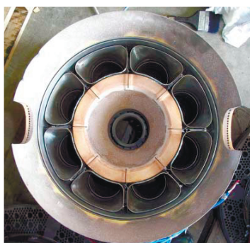
Рис. 13. Фронтное устройство МЭКС ГТУ M501G [12; 13]
