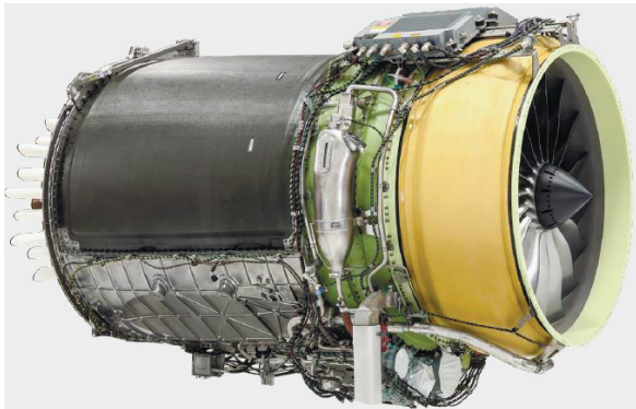
Рис. 1. ГТД Passport компании General Electric [27]
