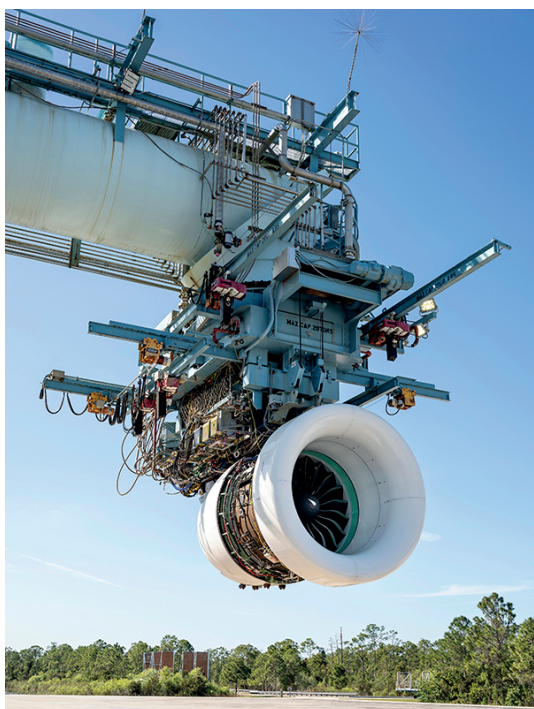
Рис. 2. ГТД GTF Advantage компании Pratt & Whitney [28]
