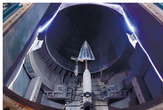
Рис. 5. Испытания планирующего блока DF-ZF [37]
