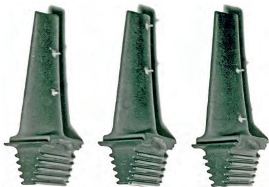
Рис. 2. Фотографии рабочих лопаток с датчиками ИМТК
