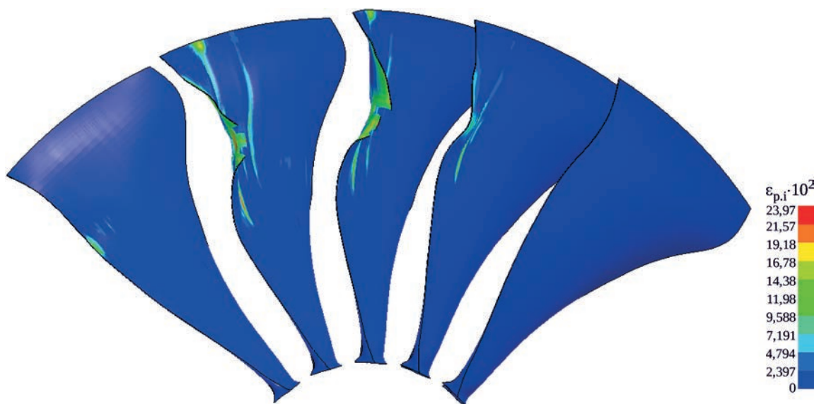
Рис. 11. Интенсивность остаточных пластических деформаций лопаток вентилятора после попадания БПЛА
