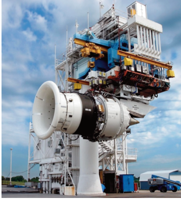
Рис. 1. Открытый стенд для испытаний ТРДД с большой степенью двухконтурности [3]
