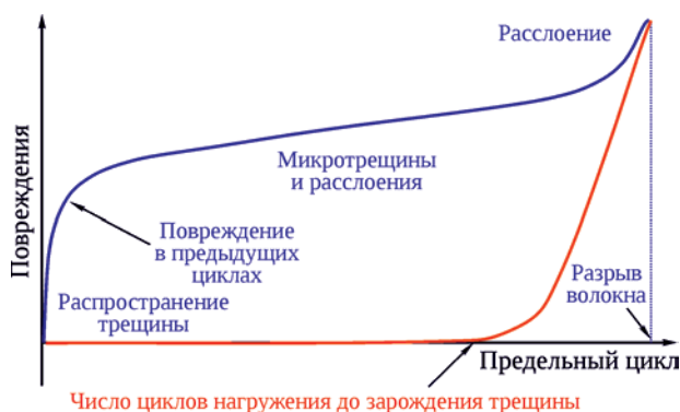
Рис. 1. Усталостное поведение металлических (красный цвет) и композиционных (синий цвет) материалов
