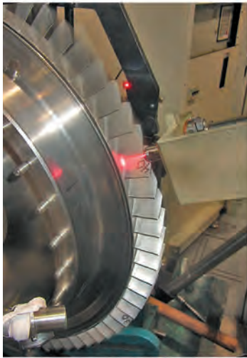
Рис. 1. Фотография и фрагмент чертежа оптоволоконного датчика, установленного над лопатками рабочего колеса КВД-7
