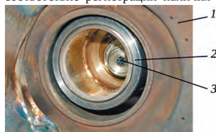
Рис. 10. Вид входного окна датчика, установленного в отверстии для свечи зажигания: 1 – корпус ФКС; 2 – корпус ЭОС-э; 3 – семижильный оптический жгут
