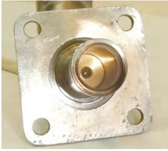
Рис. 5. Вид приемной части датчика макета сигнализатора для установки в люк ДПИ
