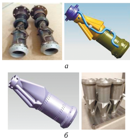
Рис. 13. Эволюция конструкции топливных горелок, разработанных компанией Siemens [43]: а – сварная; б – изготовленная посредством селективного лазерного спекания
