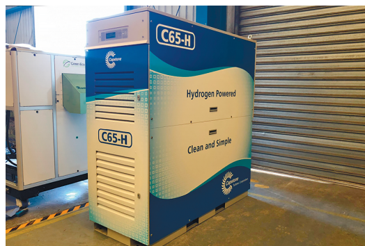
Рис. 3. МикроГТУ C65 (Capstone) мощностью 65 кВт, работающая на чистом водороде [27]
