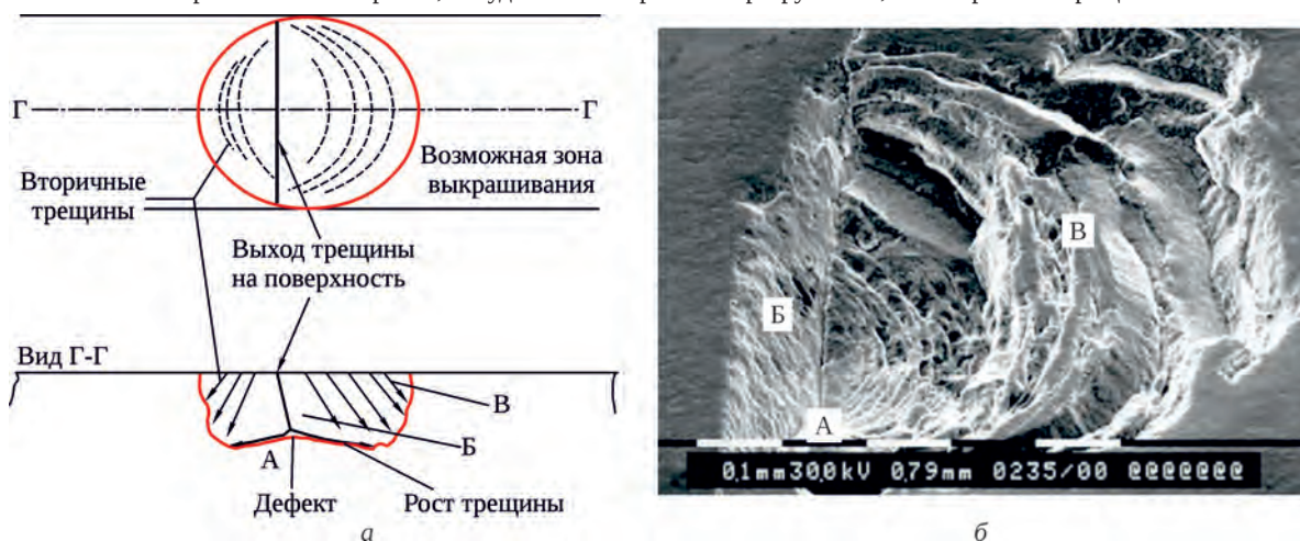
Рис. 4. Механизм развития контактного усталостного выкрашивания в нитриде кремния [30]: А – место начала разрушения; Б – развитие трещины на поверхность под небольшим углом; В – вторичные трещины; а – схема выкрашивания; б – фотография выкрашивания
