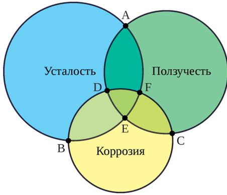
Рис. 1. Доминирующие механизмы накопления повреждений при термической усталости
