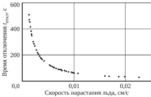
Рис. 3. Зависимость времени отключения двигателя от скорости нарастания льда
